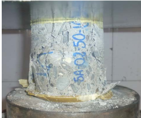
FOTO 20.-TESTIGO 5 TRAS ROTURA
