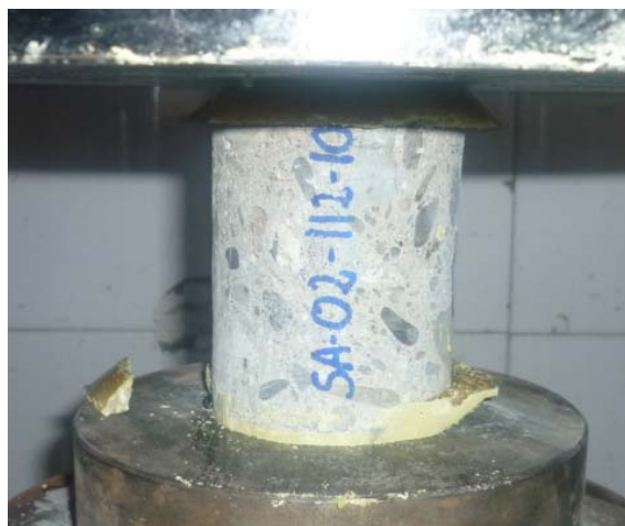
FOTO 19.-TESTIGO 4 TRAS ROTURA
