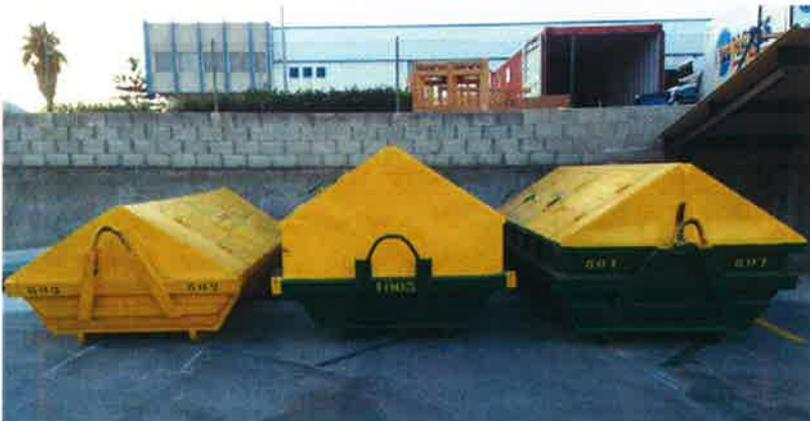
Estas cubas se cargan en los diferentes camiones con sistemas multi lift (consistentes en un gancho que hace de tracción de forma que la cuba se aloja en unas guías que se disponen y al final entran unos pestillos de seguridad. Para la descarga el proceso inverso) y son trasladadas al puerto y depositadas en el lugar especificado por el capitán.
