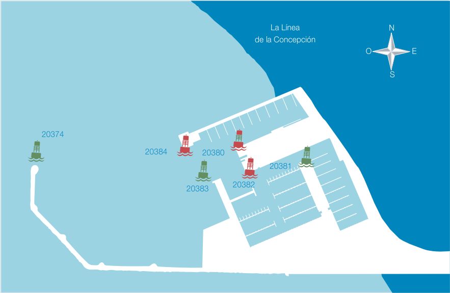
Layout of La Línea Port marking system
