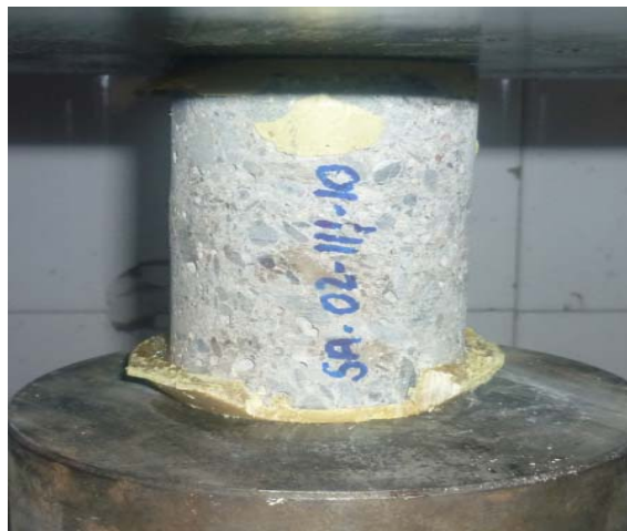
FOTO 18.-TESTIGO 3 TRAS ROTURA
