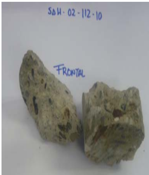
FOTO 23.-CARBONATACIÓN TESTIGO SAH-02-112-10
